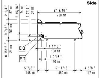
**EI** = Electrical inlet (power) Equipotential screw
