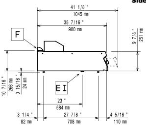
El = Electrical inlet (power) EQ = Equipotential screw
